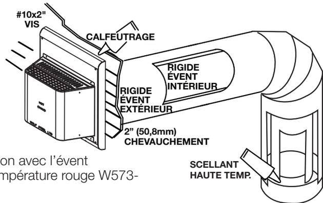
**La plaque de montage de la terminaison peut être enchâssée dans le mur ou le revêtement extérieur, sans excéder l'épaisseur de la bride.**
