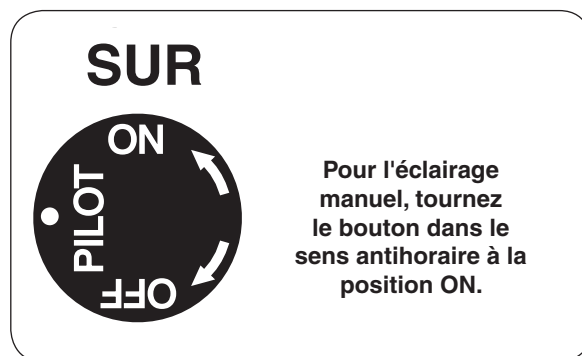
Fig. 38-3 Détail bouton de commande (SUR)
