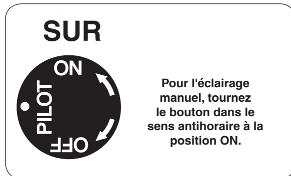
Fig. 26-1 Détail bouton de commande (SUR)
