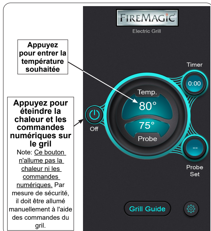
Fig. 6-3 Températures affichées sur l'application
